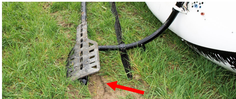
Abbildung 4: Rechte Kufe mit stark nach innen verdrehtem bear paw . Im Boden ist eine Eindruckspur vom seitlich ins Erdreich gedrückten bear paw ersichtlich (roter Pfeil).
